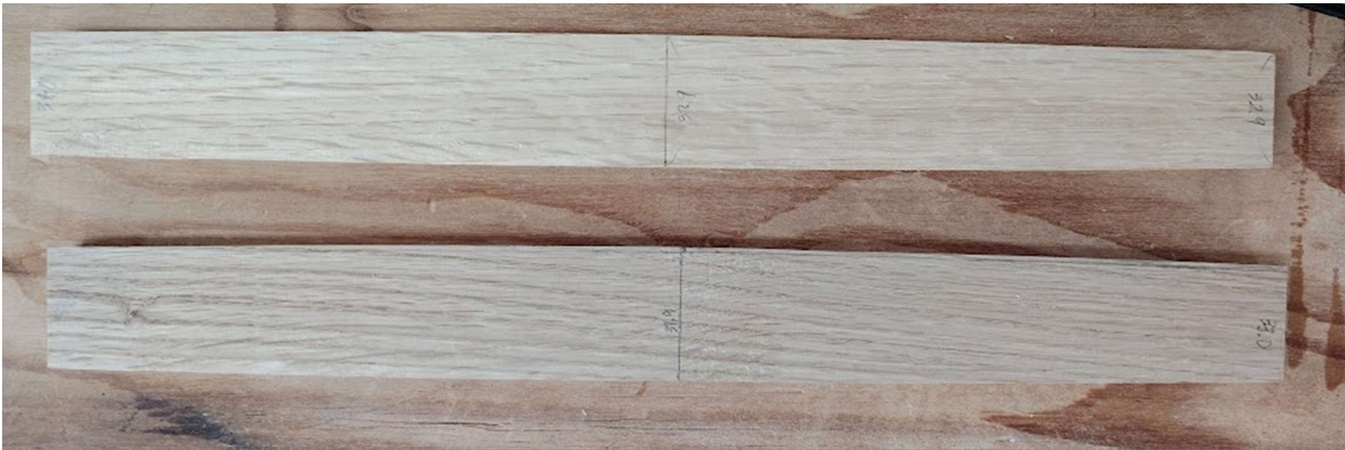
図 1 樽板の写真。両端が中央に比べて細くなっている。
