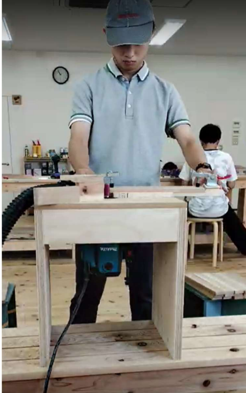
図 4 治具を用いてルーターテーブルで削っている様子
