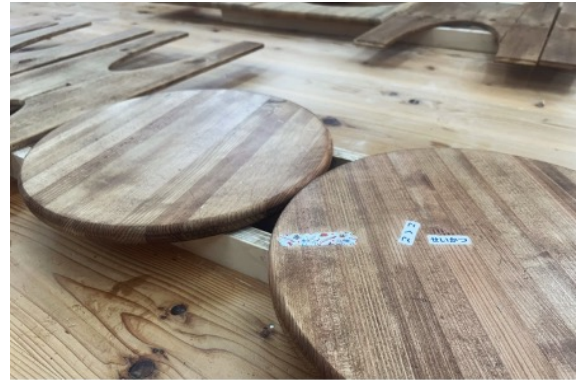
(図11) オイル塗装を行った天板と脚
