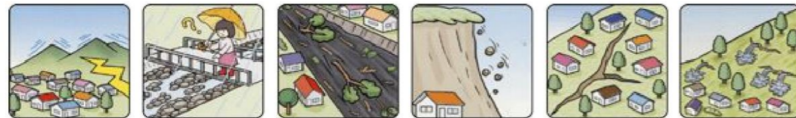
山鳴りがする 雨が降り続けているのに川の水位が下がる 川の流れが濁り流水が混ざりはじめる 小石がバラバラ落ちてくる 地面にひび割れができる 斜面から水がふき出す
